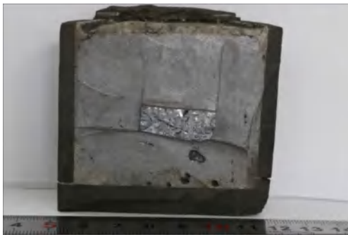
Fig. 2 Longitudinal section of silicon ingot
